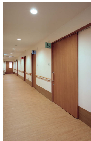
上吊片引戸 (扉閉鎖時の音の発生を低減)
